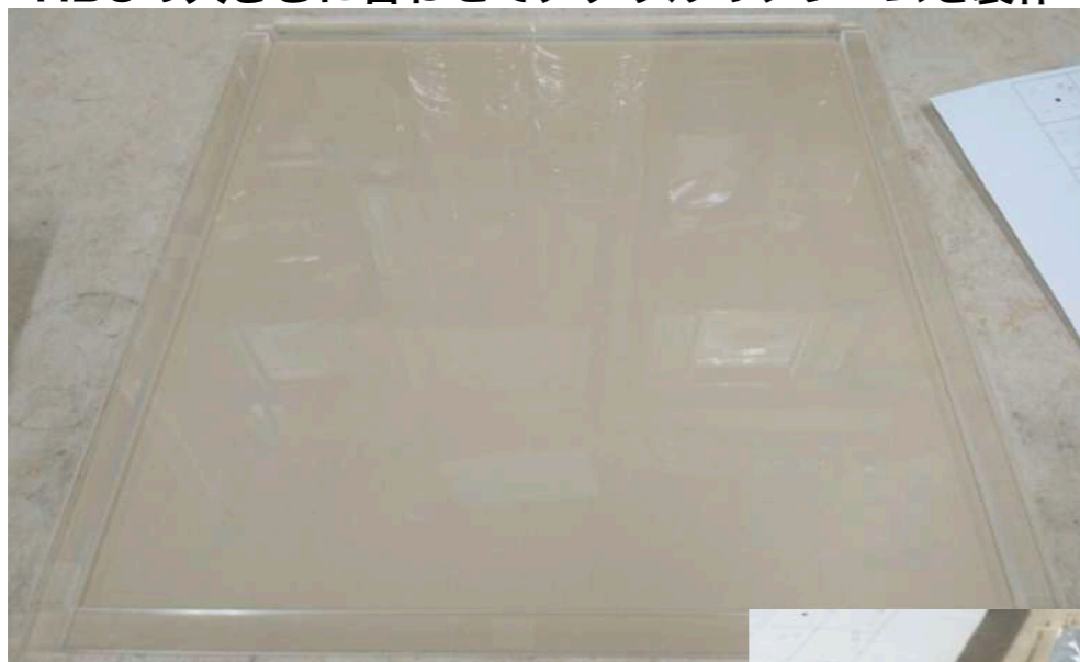
HBUの大きさに合わせてアクリルのフレームを製作
