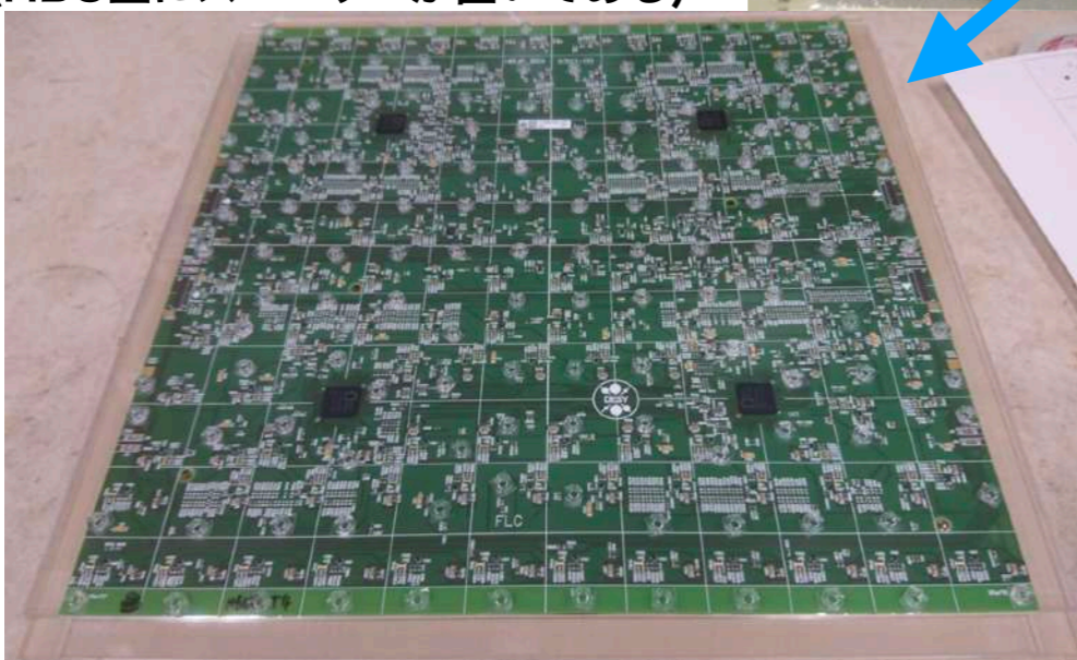
HBUを置き、その上にプレートを置く (HBU上にスペーサーが置いてある)
