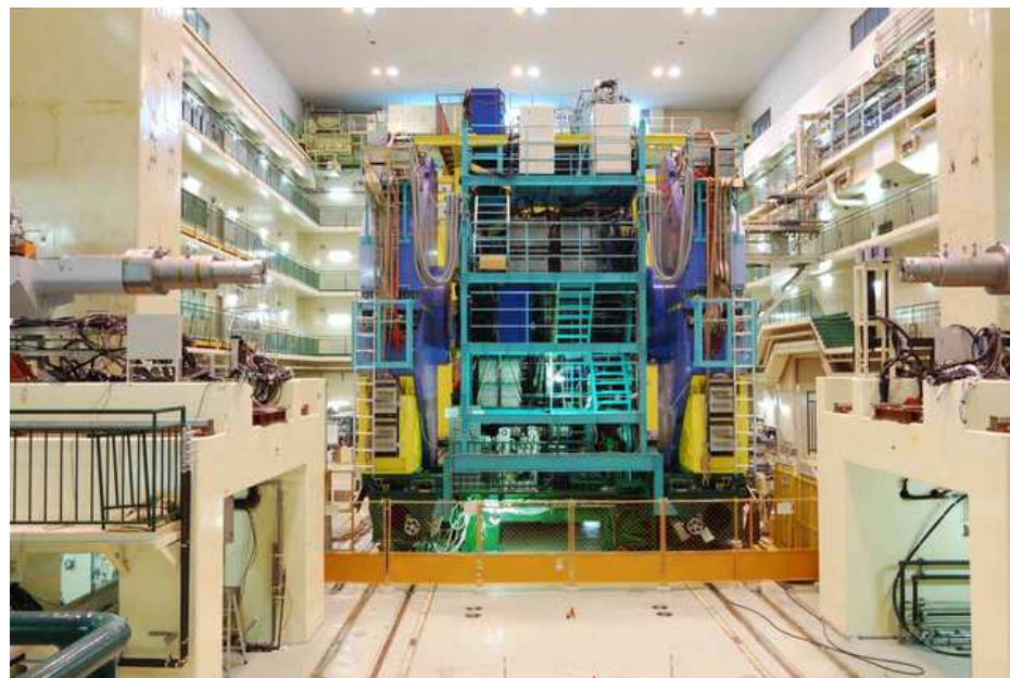
SVD 取り外し、ロールアウト後
