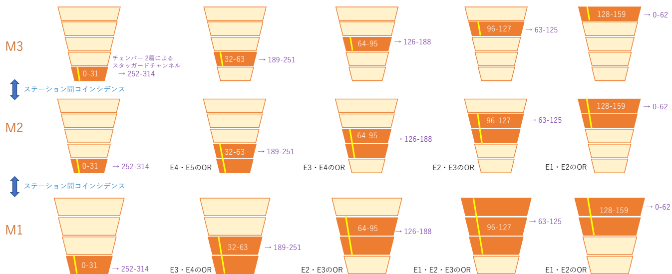
図 4.4 M3 のチェンバーとコイシデンスをとるべき M1・M2 の領域の対応関係およびステーション内コイシデンス入力のチャンネル番号とスタaggerドチャンネルのチャンネル番号の定義
