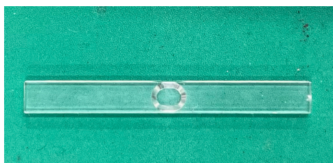
図 3.1 シンチレータストリップ
