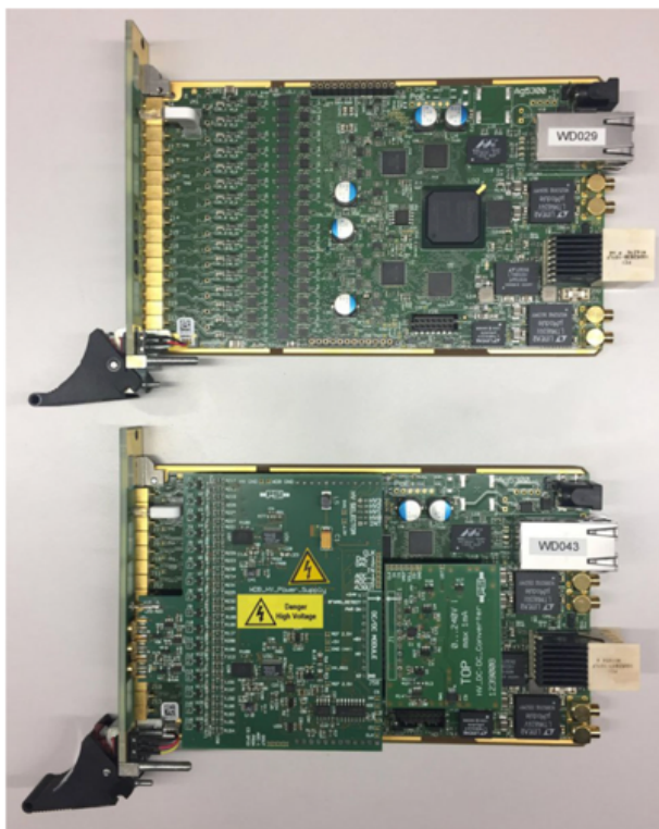
図 3.11 WaveDREAM ボード。上は HV カードが装着されておらず、下は HV カードが装着されている。HV カードが実装されている WaveDREAM ボードから SiPM に HV を印加することができる。[8]
