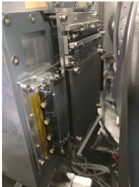
図 7.3 BGO 検出器前面に取り付けられたプレシャワーカウンター
