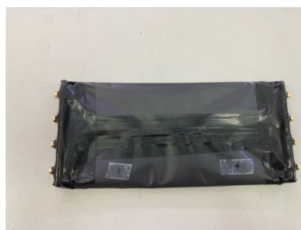
図 8.7 ブラックシートで遮光されたカウンター
