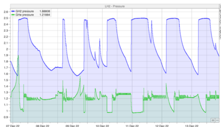
図 7.5 液体水素ターゲット内水素圧力の時間推移 (2022 年 CEX ラン)。青線が気体水素の圧力、緑線が気体ヘリウムの圧力を示す。一度ターゲットの冷却が開始すると 2-3 時間の冷却の後にターゲットの液化が開始され、ターゲット内の液体水素が十分な量に達した時点で DAQ を開始し、12 時間程度 DAQ を継続した後にターゲットの昇温により DAQ を中断するというサイクルで DAQ が行われた。
