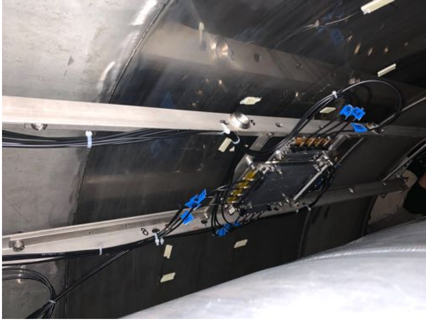
図 8.2 液体キセノン検出器の前面に設置されたリファレンスカウンター
