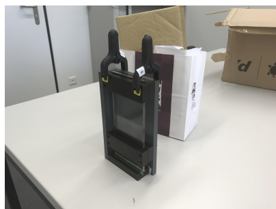
(b) SiPMを接着する面を下にし、1日ほど放置する。
