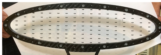
図 3.17 MEG II 実験の \mu ビーム静止ターゲット [10]。モニター用のパターンが印刷されている。
