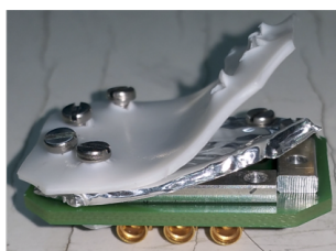
図 8.2 LED type 1 の外観。LED の前面に穴を開けたアルミ箔を被せて減光し、その上からテフロン製のディフューザを被せている。
