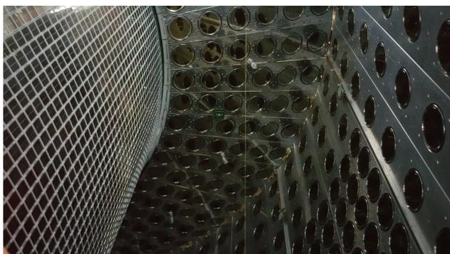
図 1.2 MEG II 実験液体キセノンガンマ線検出器の内部。左の入射面には新しく導入された MPPC が敷き詰められており、他の面は PMT で覆われている。
