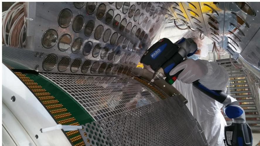
図 8.2 レーザースキャナーを用いた測定の様子。側面からレーザースキャナーを入れ、MPPC の表面近くからレーザーを照射している。
