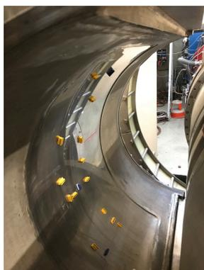
図 9.31 入射面に接着された鉛ストリップ
