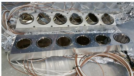
図 4.19 側面における PMT の置き方の変更。変更前 (上) は光電面が側面に平行では無いが、変更後 (下) は側面に平行になり飛びだしていない。
