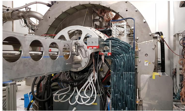
図 11.10 下流側から見た CW ビームラインの bellows
