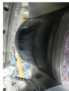
図4.15 検出器内壁に取り付けられたCFRP
