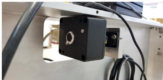
図 9.7 レーザー光のヒット位置を測定する Quadrant Photo Diode(QPD)。支持機構に固定されている。
