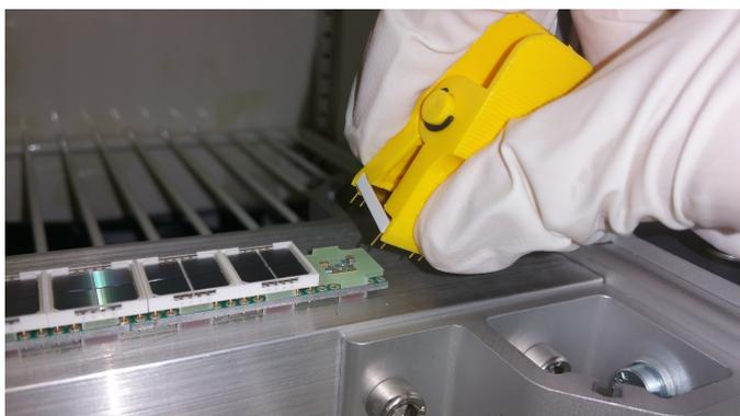
図4.14 MPPCをPCB上にのせていく様子。緑色の物体はスペーサーである。
