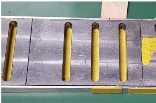
図 11.2 2017 年のパイロットランにおいてインストールしたコリメータ。水平方向のスリット幅は 1 cm、スリット間隔は 3.8 cm であった。
