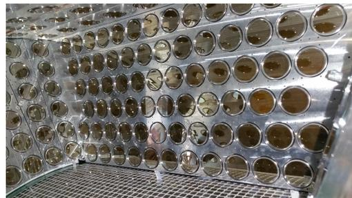
図 4.20 トップ面における PMT の配置。密に配置することによって集光効率を高めている。
