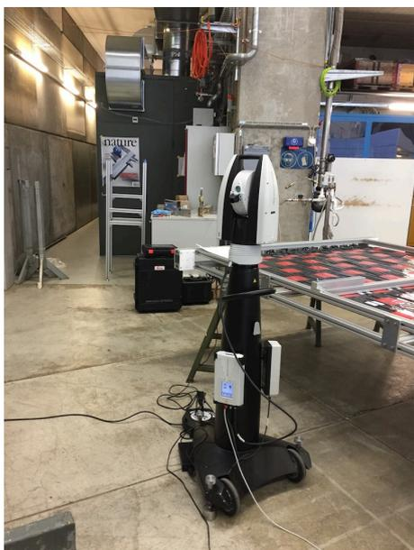
図 9.13 レーザートラッカー
