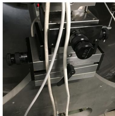
図 9.10 精密ステージ (下流)。両端での装置の位置を調整することができる。
