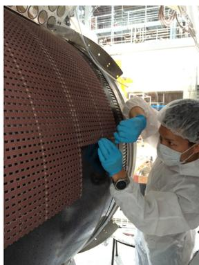
図4.16 CFRP上に取り付けられたスペーサー
