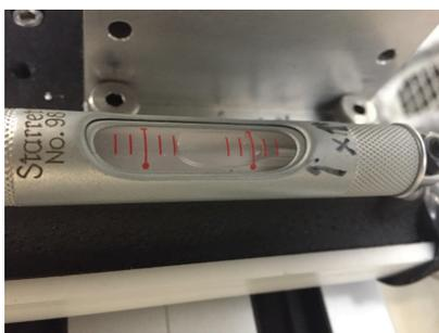
図 9.8 Z 軸周りの回転をモニターする水準器。赤い読みは 0.4 mrad に対応している。
