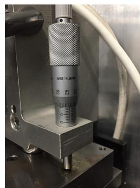
図 9.12 z 軸まわりの回転を固定するためのマイクロメータ。下流側にのみつけられている。
