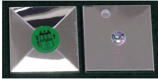
図 5.40: 反射材の巻かれたシンチレータタイル
