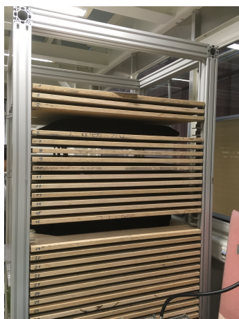
図 5.29: HBU ラックに導入された宇宙線カウンタ。ラックの6番と19番に2台のカウンタがそれぞれ入れられている。
