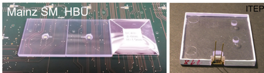
図 2.4: シンチレータタイル [9]。左は現在の標準である中心読み出しであり、右は側面読み出し。
