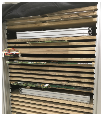
図 5.30: 試験装置と検出層の配置。アルミフレームに入れられた2台の宇宙線カウンタと、その間に3層のHBUが差し込まれている。真ん中のHBUが試験する対象。
