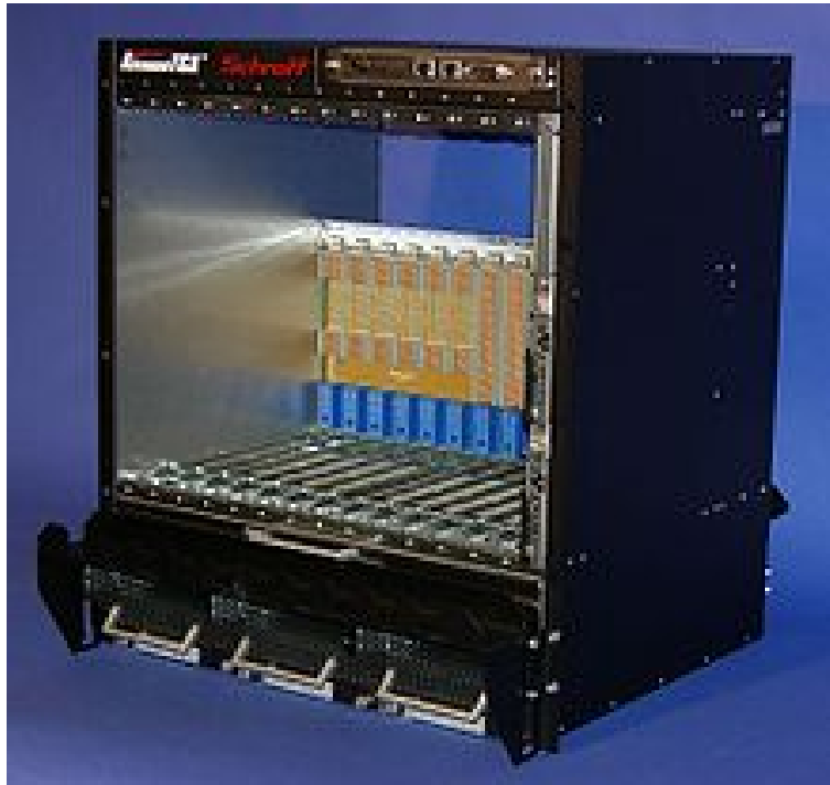
図 3.8: ATCA プラットフォーム [9]。この ATCA は 14 スロットあり、高さ 12 U の (~53 cm) である。
