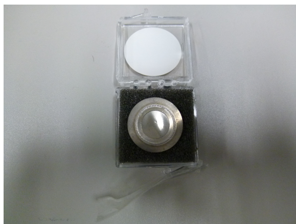
図 3.4: 使用した放射線源パッケージ。モデルは Eckert & Ziegler, POSN-22 である。 ^{22}\text{Na} 同位体は厚さ 11.7 \mu\text{m} の Ti フォイルに挟まっている。
