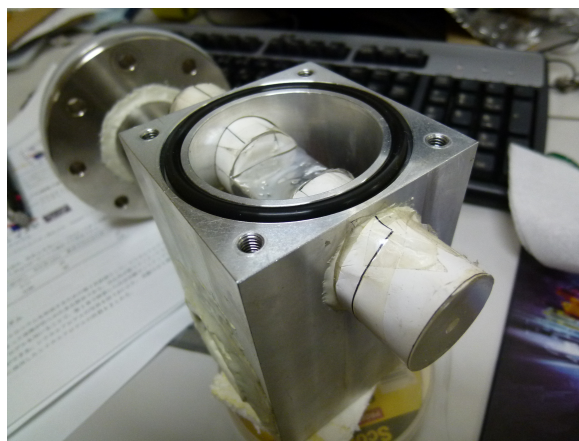
図 3.6: ライトガイド。光の収集効率を高めるために反射材が巻きつけてある。真空チャンバーに接着剤を用いて固定している。写真上部より、線源ホルダー付きのフランジでフタをする。
