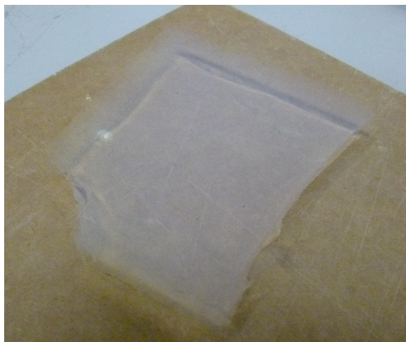
図 3.8: シリカエアロゲルの写真。ここから 28\text{ mm} \times 28\text{ mm} \times 5\text{ mm} 片を 2 つ切り出した。
