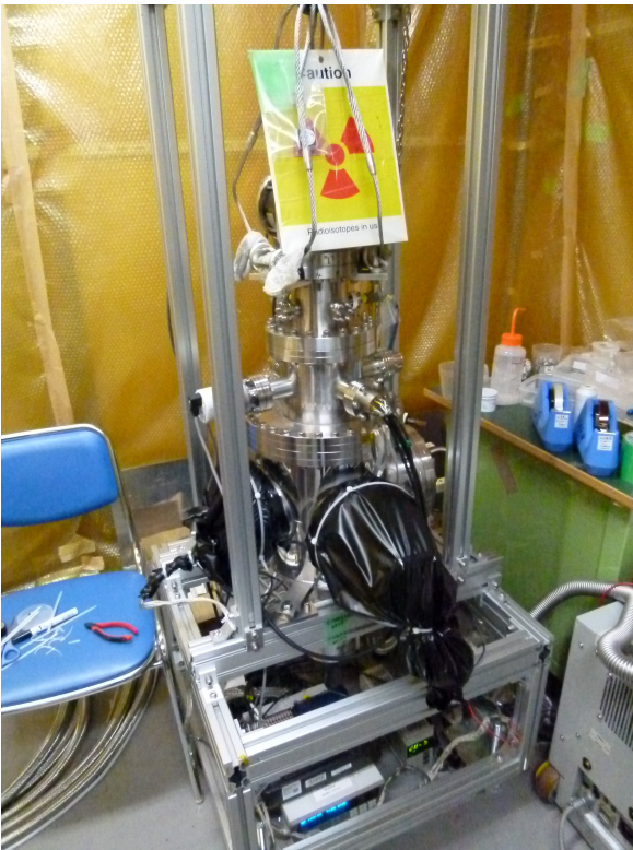
図 5.6: 実験セットアップ全体図。PMT を黒い遮光シートで覆っている。
