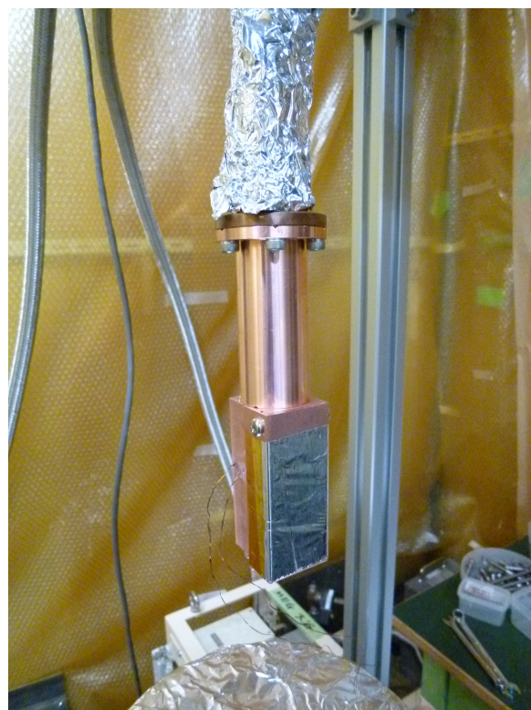
図 5.3: GM 冷凍機の 4 K ステージに取り付けたターゲットホルダー。全方向をネジ止めした銅で覆うことで極力熱流入を減らす。陽電子のパスは銅に穴を空け、厚さ 6 \mu\text{m} のアルミ蒸着マイラーでふさぐ。4 K ステージ全体は、GM 冷凍機 50 K ステージに取り付けた銅製の放射シールドで覆う。
