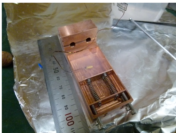
図 5.2: 4 K 熱化測定実験で使用するシリカエアロゲルとターゲットホルダー。Si ダイオードセンサーをシリカエアロゲルの間に挟み温度を取得する
