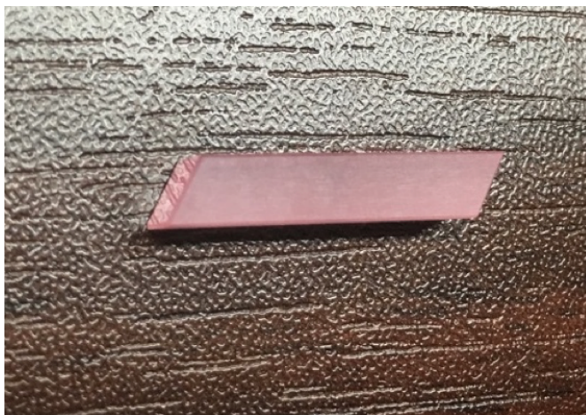
図 4.11: 使用した Ti:Sapphire 結晶。結晶の全長は 20 mm。型番は, CRYSTAL SYSTEMS 社 PO#: CSI-1374 である。
