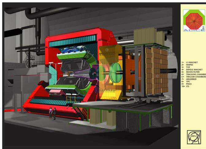
図 2.7: ALICE 検出器の概略図 [9]. QGP の検証などを行うための重イオン検出器.
