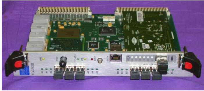
図 3.13: ROD の写真 [11]. ROD は TGC の読み出しデータが最終的に集まるハードウェアモジュールで後段の ROB のためのフォーマットに整形する役割をもつ。
