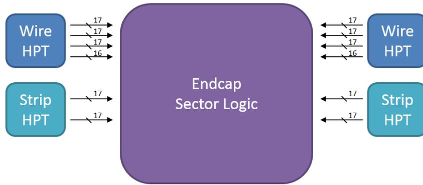
図 4.2: HPT とエンドキャップ SL との信号線の様子. HPT から 202 bit の入力がある.
