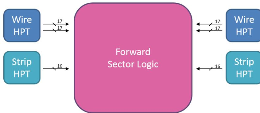
図 4.3: HPT とフォワード SL との信号線の様子. HPT から 100 bit の入力がある.
