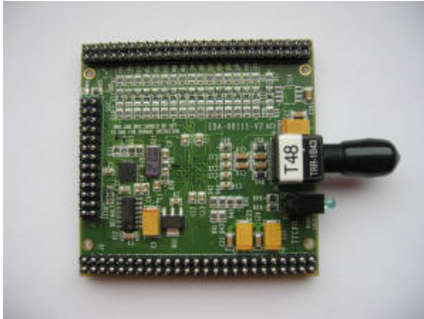
図 4.7: TTCrq. TTC 信号を受信する. PT7 に接続可能.
