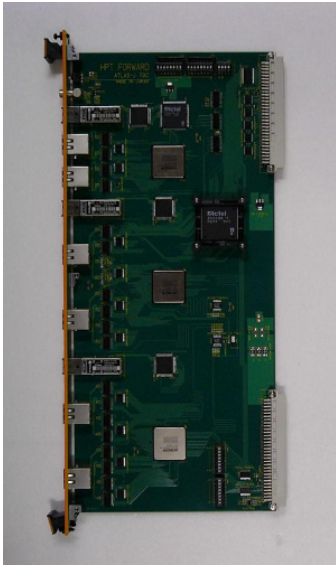
図 2.14: HpT ボードの写真 [22]. HpT ボードは Doublet と Triplet のコインシデンスをとる.
