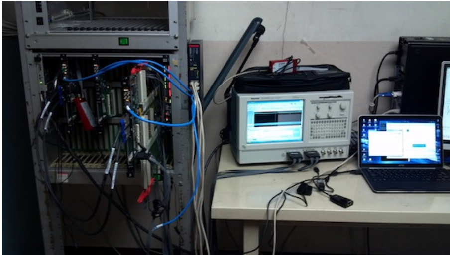
図 5.2: PT7 SiTCP 性能評価試験 環境. 白いケーブルは cat6 3m, 青は 100BASE-TX 用 1m.
