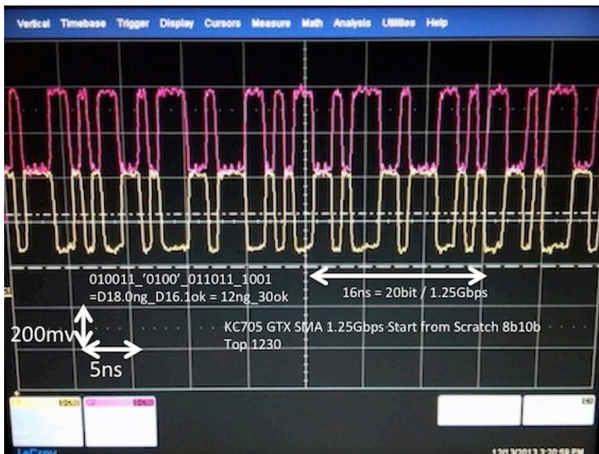
図 5.10: 8b10b ありの波形. 周期は 16ns で変換データも正常.
