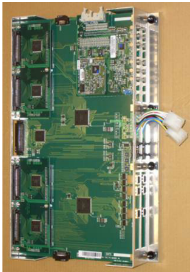
図 2.12: PS ボードの写真とブロック図 [23]. PS ボードは PP, SLB などの ASIC を持つ.
