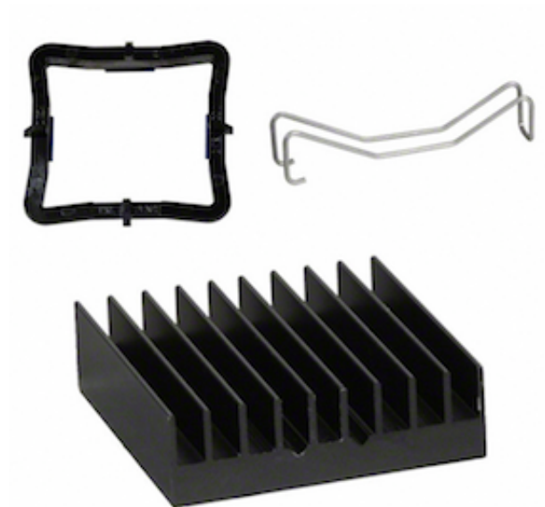
図 5.12: 検討中の放熱板 ATS-53310D-C2-R0. 500\text{LFM}^2 で 6.3\text{ }^\circ\text{C/W} の熱抵抗を持つ.
