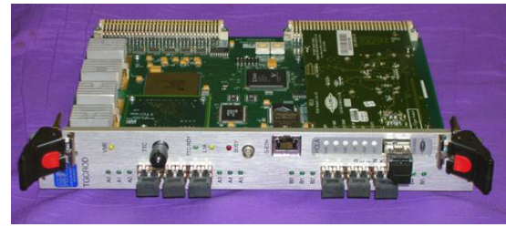
図 2.19: ROD[15]. TGC の読み出しデータが最終的に集まる装置である。データを ATLAS 共通の形式にする。
