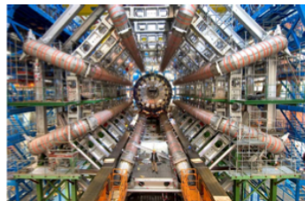
図 3.27: トロイド磁石 (バレル部)
