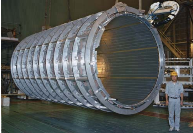
図 2.25: 電流を \phi 方向に流す事で、飛跡検出内に z 軸方向に 2T の磁場をかける。この磁場によって飛跡検出器内の荷電粒子を \phi 方向に曲げる。
