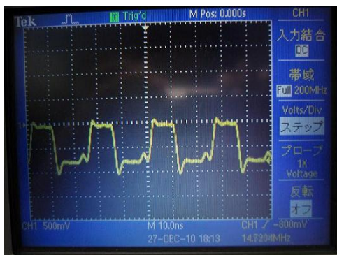
図 3.42: クロックを NIM 出力で直接見たときの様子
