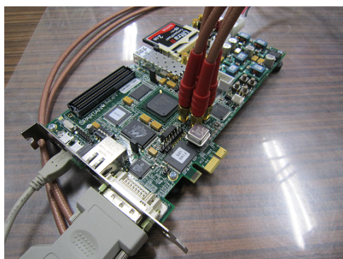
図 3.10: SMA ケーブルでループバックしている様子
