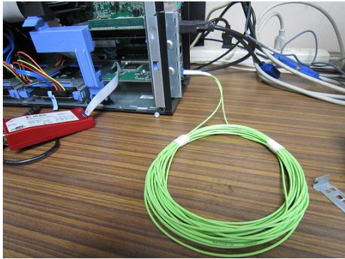
図 2.18: PCI-CCI のループバックテストの様子
