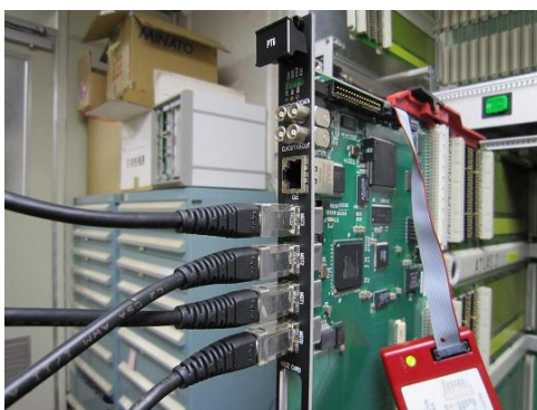
図 3.23: Rocket IO GTP 送受信テスト
