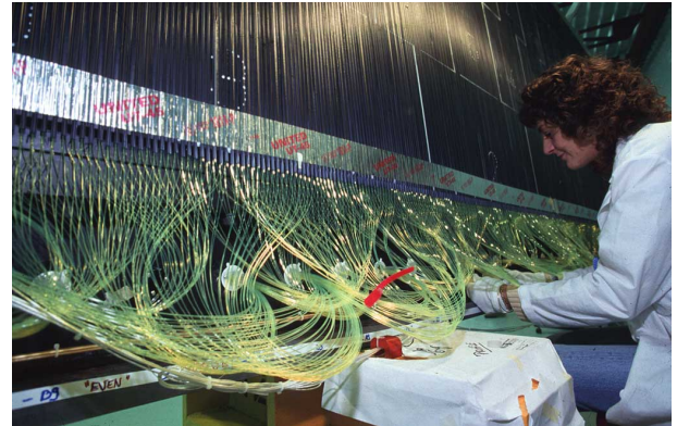
図 3.17: タイルカロリメータの組み立ての様子: 各タイルの信号は、2本の波長変換ファイバーによって読み出される。
