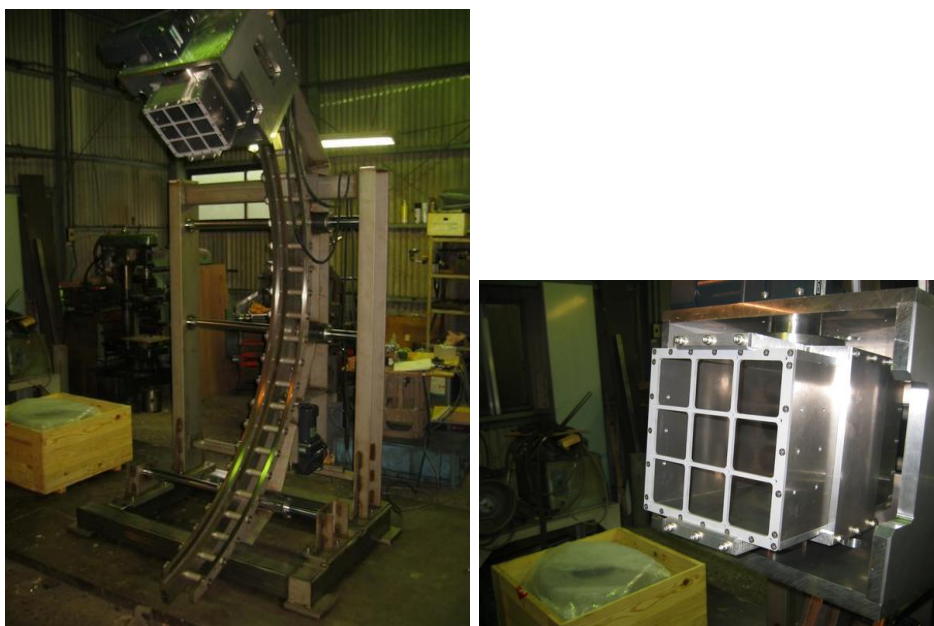
図 2.4: 製作された NaI+APD 検出器用駆動装置
