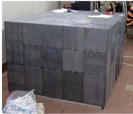
図 2.40: 検出器組み立ての様子3 完成形 (5mmの鉛で検出器全面を覆う)
