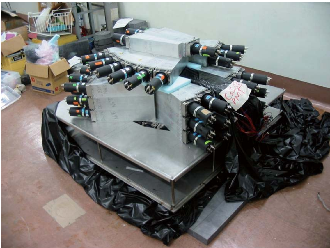
図 2.41: 検出器組み立ての様子2 検出器の全貌 (全ての検出器を組み終える)
