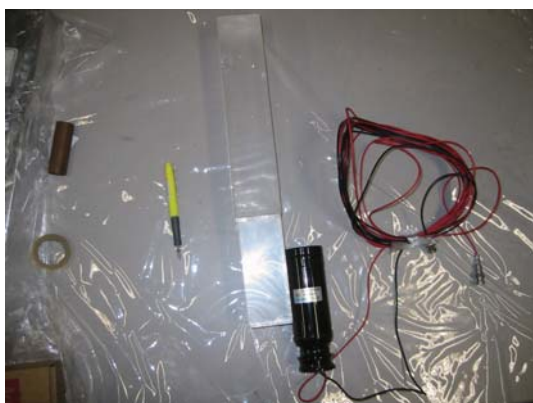
図 2.24: 昔の実験で使われた CsI(Tl)
