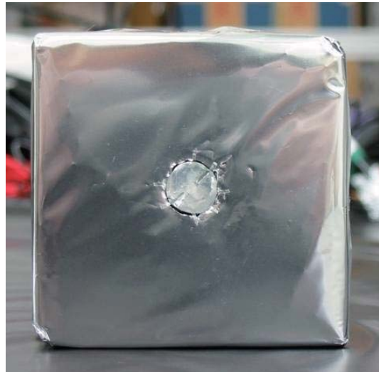
図 2.8: sourceCsI 実物の正面図 (プラスチックシンチレーターが穴の隙間から見える)
