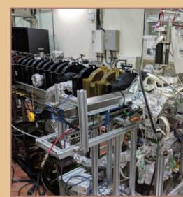
ポジトロニウム冷却実験装置。黒いガイドコイル中を左から薄かれた陽電子ビームが、銀色のチェンバー中でポジトロニウムを生成する。右から紫外レーザーを照射することで、ポジトロニウムを冷却する。
