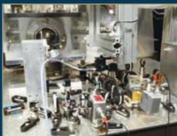
強磁場による真空の歪みを探索する装置。強磁場中を通過しわずかに偏光が変わった赤外線レーザーが、左奥の丸い窓から出てくる。手前に配置された光学素子でその微小な変化を検出する。
