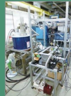
高出力サブテラヘルツ波光源-ジャイロトロン。福井大学が開発したこの装置に、浅井研究室が開発した装置を組み合わせ、ポジトロニウムの状態間のエネルギー差を世界で初めて観測することに成功した。
