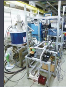
高出力サブテラヘルツ波光源-ジャイロトロン。福井大学が開発したこの装置に、浅井研究室が開発した装置を組み合わせ、ポジトロニウムの状態間のエネルギー差を世界で初めて観測することに成功した。
