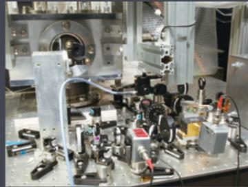
強磁場による真空の歪みを探索する装置。強磁場中を通過しわずかに偏光が変わった赤外線レーザーが、左奥の丸い窓から出てくる。手前に配置された光学素子でその微小な変化を検出する。
