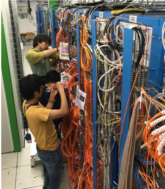
図 1 新しいミューオントリガー回路を実験室に設置し、データ転送のための光ファイバーを接続している齋藤助教(手前)。名古屋大、京都大、神戸大の大学院生を指揮している。
