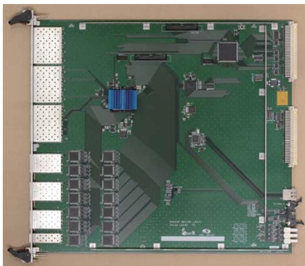
新たに開発したLevel-1ミュオントリガー回路。2018年に全数作成し試験を完了した。すべての必要な機能を実装したファームウェアの開発・試験をおこなった。
