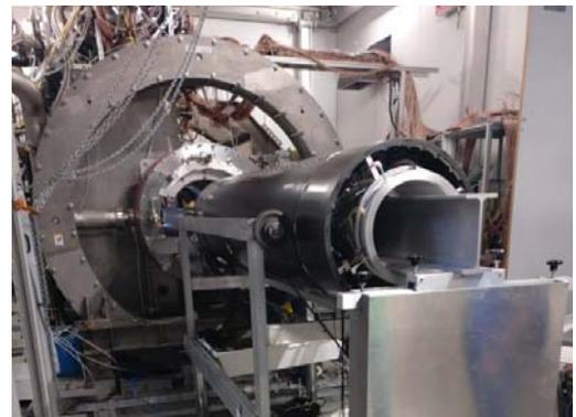
図 2 スペクトロメータマグネットに挿入されるドリフトチェンバー
