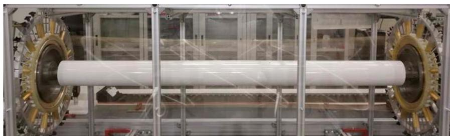
図4 ワイヤー張り作業中の飛跡検出器
